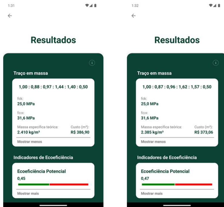
Figura 6 – Seção Traço em massa dos resultados do método ABCP (esquerda) e IPT (direita) para os dados informados.
